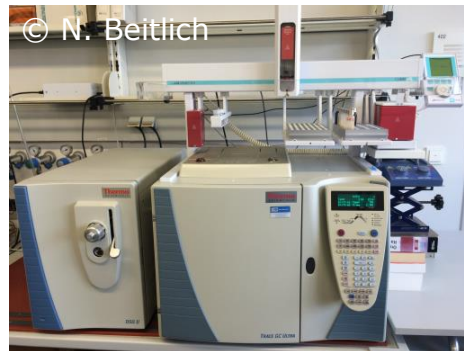
GC-MS = Gaschromatographie- Massenspektrometrie
